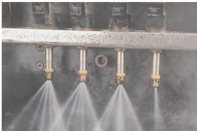
图 2.7 检查喷油器雾化
