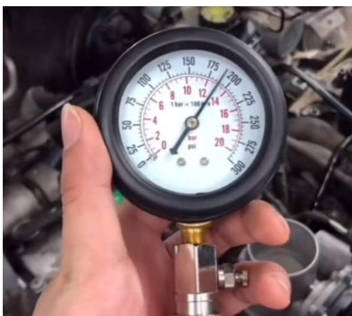
图 2.4 测量气缸压力
